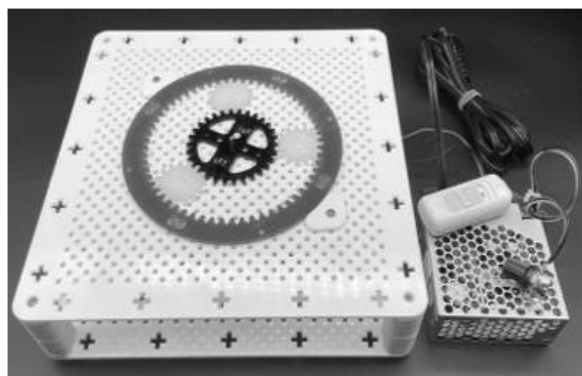
図 1 遊星歯車機構のメカ設計教材
