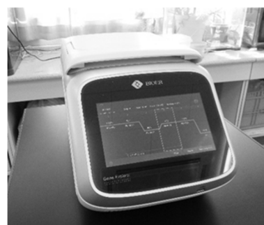
図1: 本実験で用いたサーマルサイクラー（日本ジェネティクス製）PCR法はどの教科書にも記載があるため、機器の共用あるいは貸与等のシステム構築も課題であると考えている。
